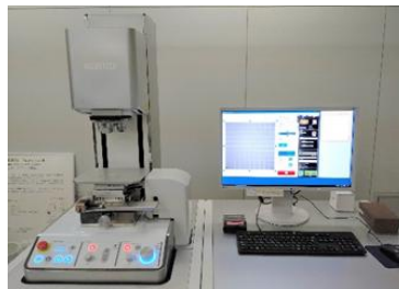
白色干渉型表面形状測定機 (株) 東京精密 製 Opt-scope R
